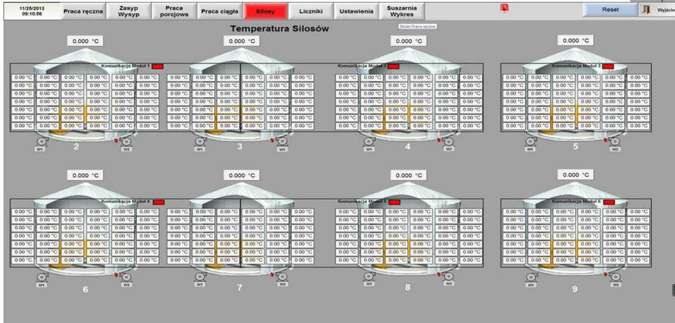
Отчет возможен с помощью приложения управления объектами, которое позволяет автоматически контролировать вентиляцию внутри силосов и позволяет архивизовать данные. В случае небольшого числа зондов мы можем использовать портативный терминал, из которого мы можем считывать до двух зондов из одного модуля.
